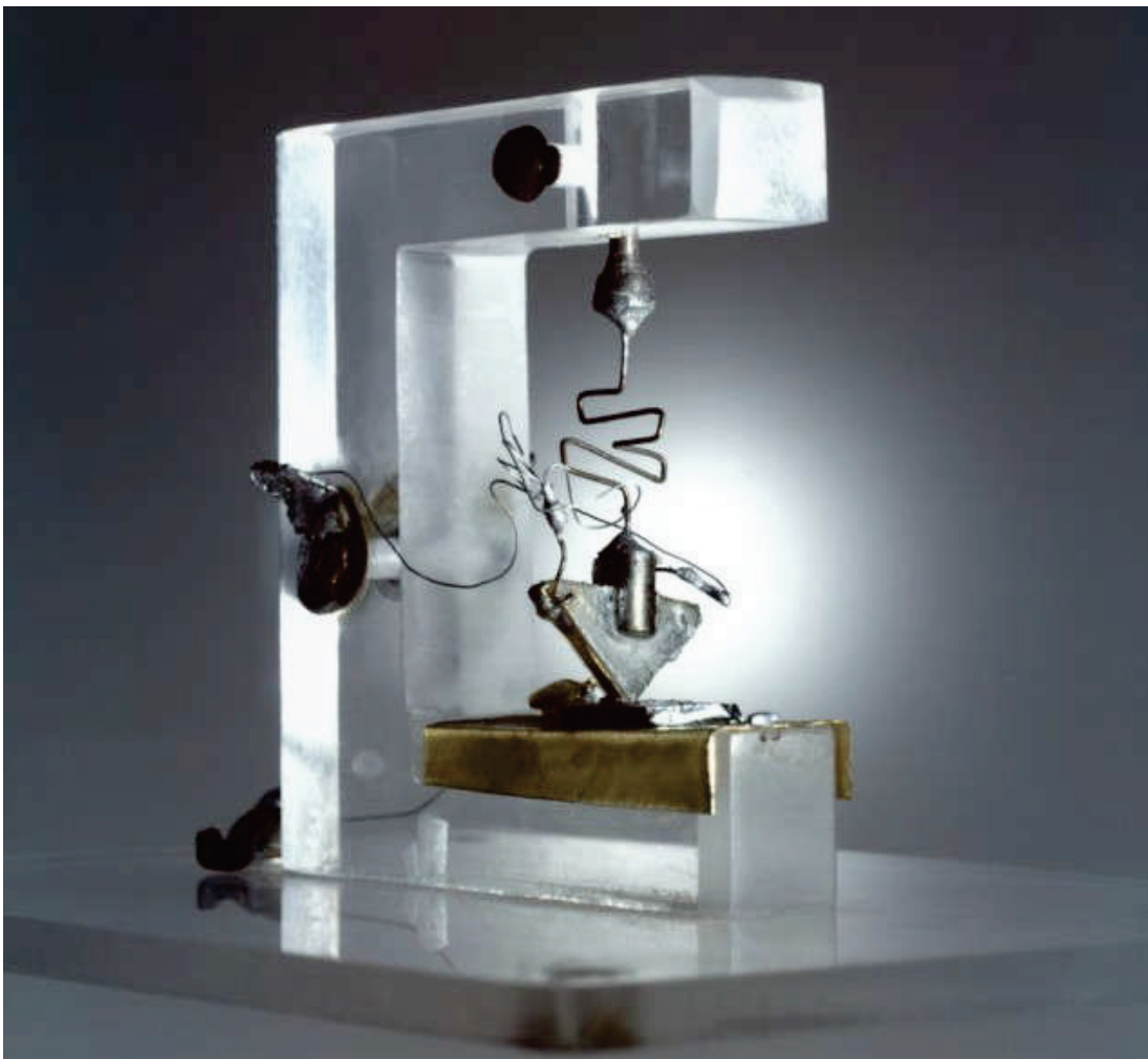
Izgled prvog germanijumskog bipolarnog tranzistora napravljenog 1947. god. u Belovim laboratorijama
